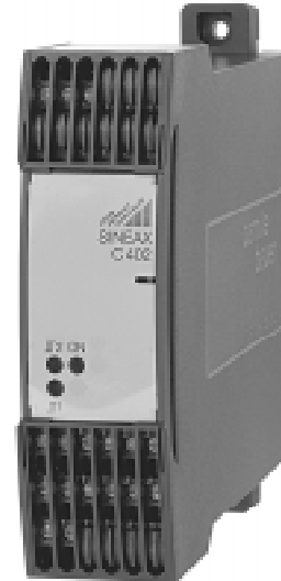
Bild 2. SINEAX C 402-4 mit 2 Relaisausgängen mit je 2 Wechselkontakten, im Gehäuse S35 mit herausgezogenen Laschen für direkte Wandmontage.
